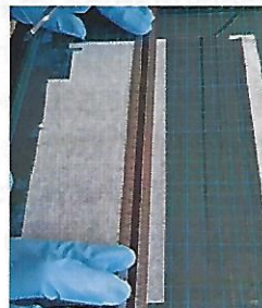
Vorbereitung zur Verstärkung mit zweiter Glasplatte
