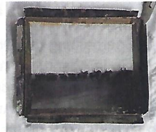
Trennen von der zweiten Glasplatte
