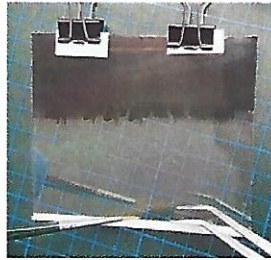
Anbringen der zweiten Glasplatte
